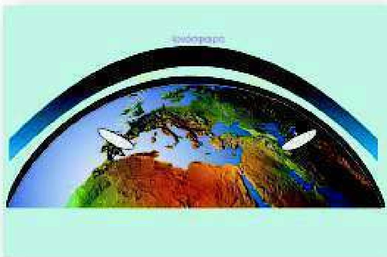
Σχήμα 1.21: Μετάδοση κυμάτων χώρου
