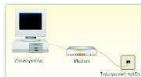
Σχήμα 1.28: Διασύνδεση υπολογιστή με την τηλεφωνική γραμμή μέσω διαποδιαμορφωτή (modem) για επιλογική (dial-up) σύνδεση
