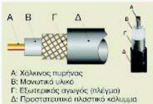
Σχήμα 1.14: Το ομοαξονικό καλώδιο
